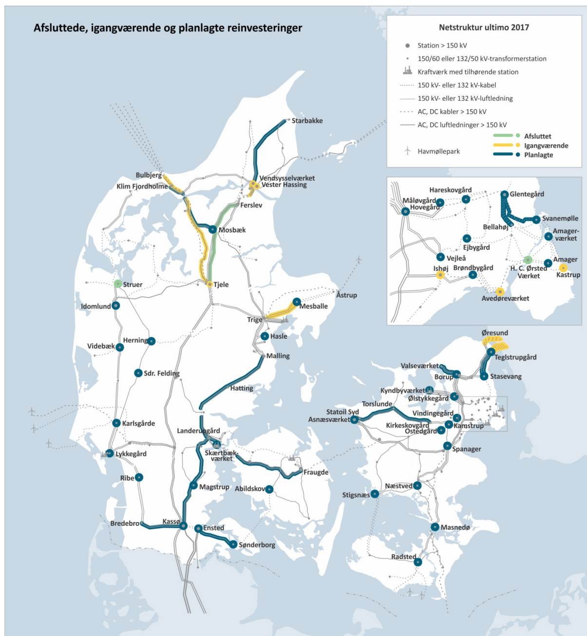
Figur 15 Den geografiske placering af afsluttede, igangværende og planlagte reinvesteringsprojekter. Transformerreinvesteringer er ikke vist på kortet.
